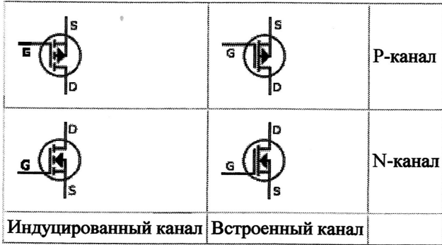
Рис. 7.17. Условные графические обозначения МОП-транзисторов: G – затвор; S – исток; D – сток
